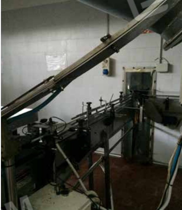
26. Nastro trasportatore che parte dalla sala di lavaggio a quella di lavorazione (Edificio A).
